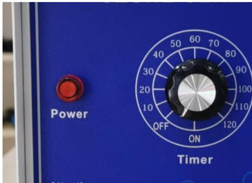
**Temporizzatore e spia di funzionamento**
